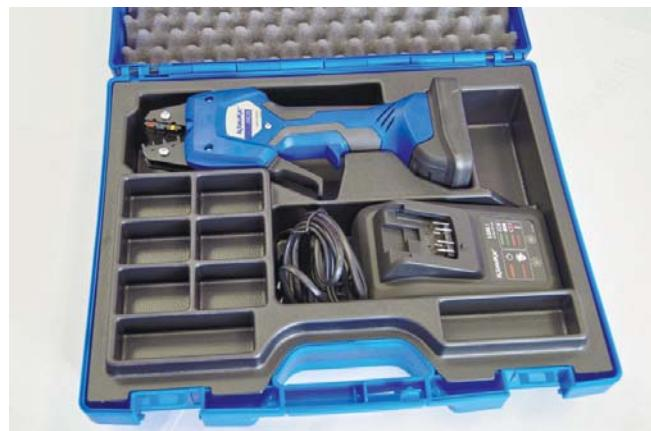
В базовый комплект поставки инструмента KLAUKE-Micro, имеющий артикул EK50ML, входит сам инструмент с аккумулятором, зарядное устройство и фирменный пластиковый кейс с внутренней вставкой, разбитой на ячейки. В ячейках можно хранить нужные матрицы или упаковки с наконечниками. В этой комплектации в инструмент уже установлены матрицы для опрессовки изолированных наконечников до 6 мм<sup>2</sup>.
